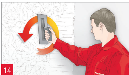
A kapart vagy dörzsölt struktúrájú vakolat körkörös irányú dörzsölése.
